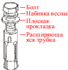
Рис. 3-6 Конструкция и установка расширительного болта
