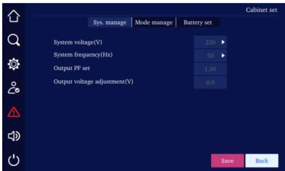
Рис4-20 Настройки шкафа ИБП. Вкладка Sys.manage/Системные настройки
