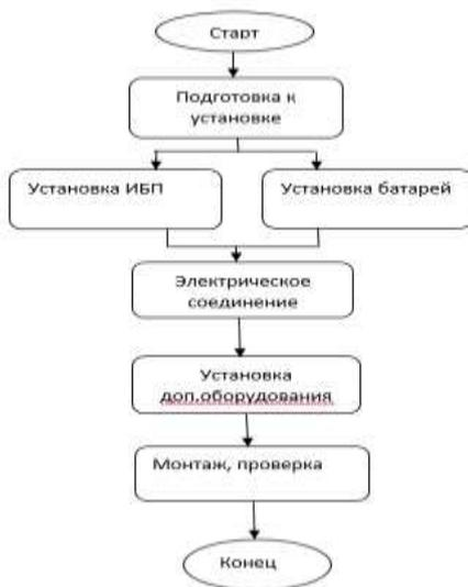
Рис3-1 Алгоритм установки ИБП
