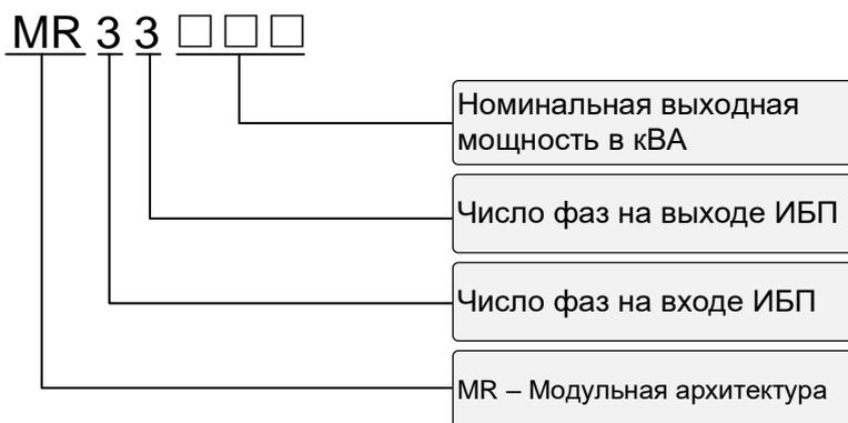
Рисунок2-1 Обозначение модели устройства
