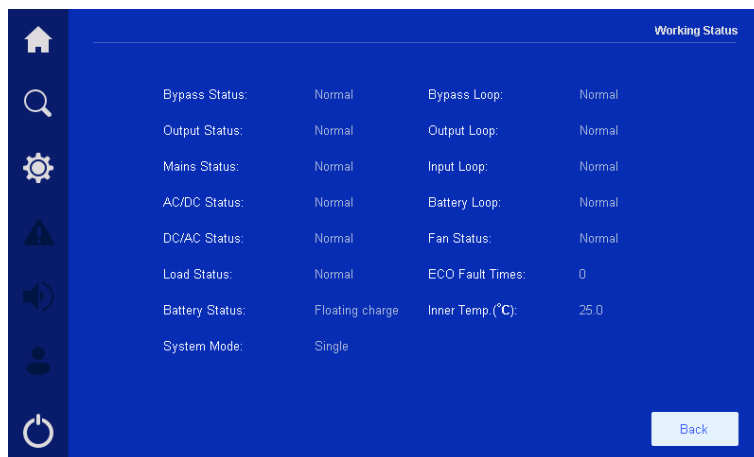
Рис 4.18 Страница информации о режимах работы и состоянии ИБП. Одиночный ИБП.
